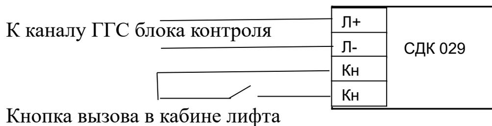
Требования п.2 обеспечивается установкой технологического переговорного устройства СДК-029Т или, в случае отсутствия свободной пары в лифтовом шлейфе - СДК-029К, на крыше кабины лифта.
