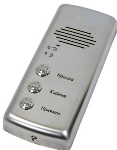
Трехканальный пульт служебной связи СДК-035.3М используется для обеспечения служебной связи в лифтах по ГОСТ Р 53780-2010 между машинным помещением и кабиной лифта, машинным помещением и крышей кабины, машинным помещением и первым этажом (прямком). Пульт устанавливается в машинном помещении или рядом с устройством управления лифтом для
