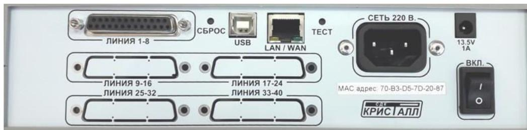
**Рис. 3. Верхняя панель блока сопряжения СДК-33.Х S/S1**
