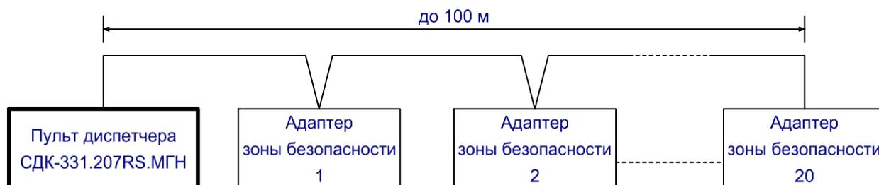
**Рис 3. Подключение зон безопасности. Конфигурация 1.**
