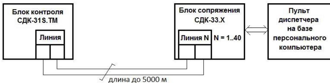
**Рисунок 2. Подключение блока контроля к пульту диспетчера**
