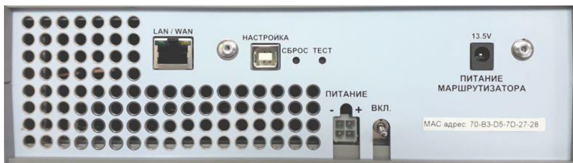
Рис. 16. Внешний вид нижней панели блоков контроля СДК-31.3XX
