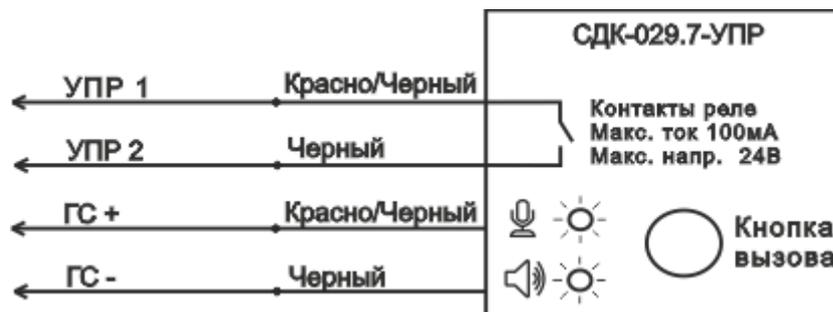
Рис. 2. Подключение СДК-029.7-УПР
