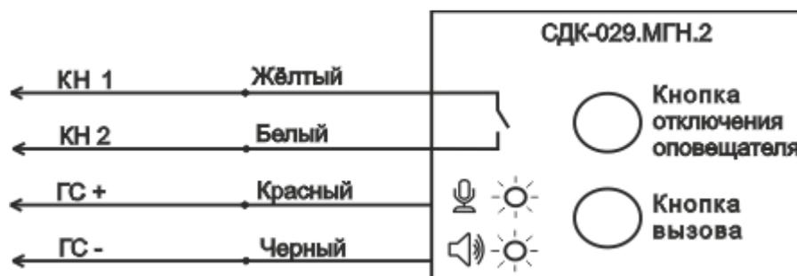
Рис. 1. Подключение СДК-029.МГН.2
