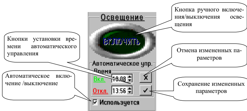
Рис. 15. Панель управления освещением.
