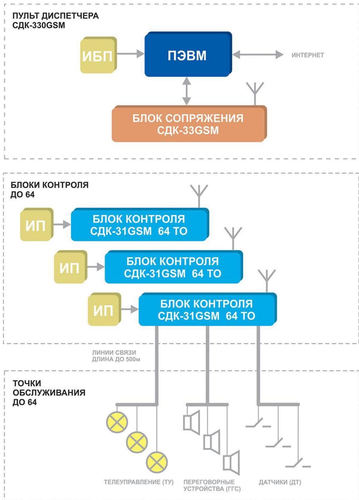
Рис.3 Структурная схема системы на базе комплекса «Кристалл-GSM»
