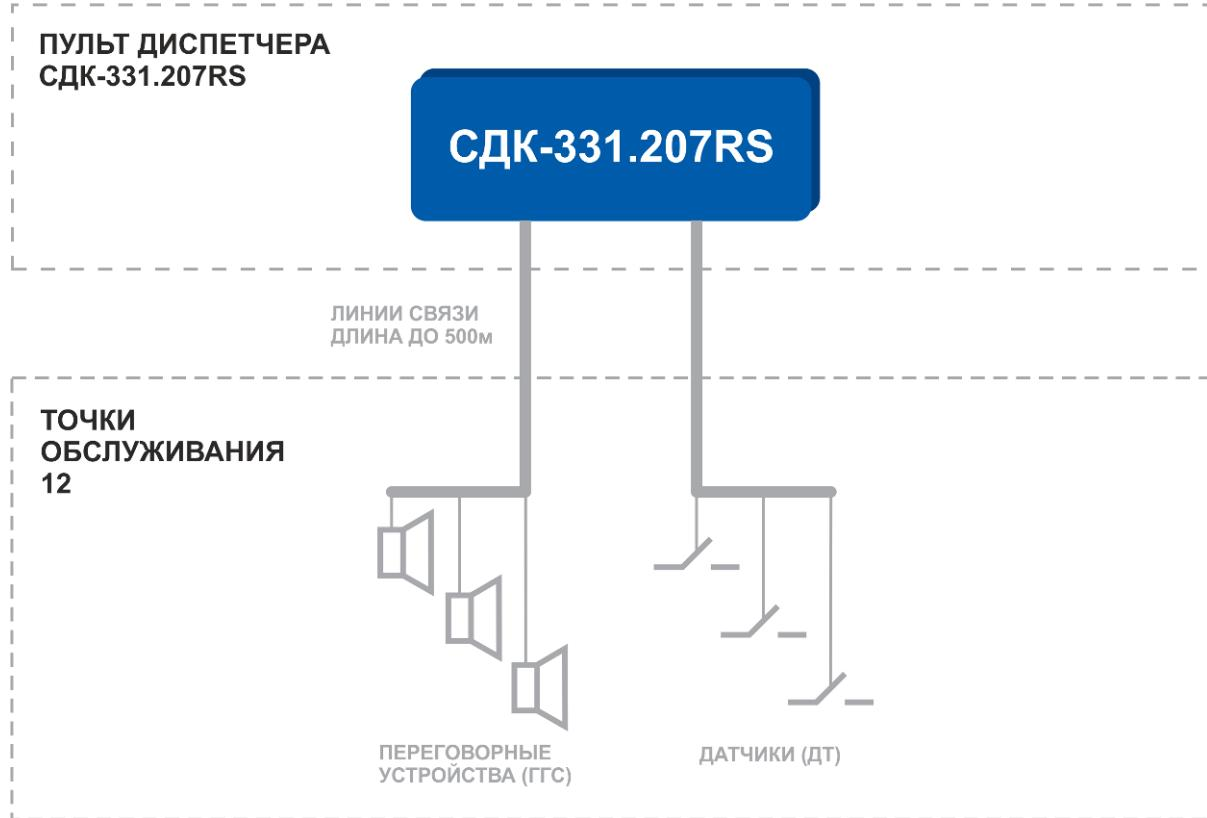
Рис. 4.2 Структурная схема системы на базе пульта СДК-331.207RS.
