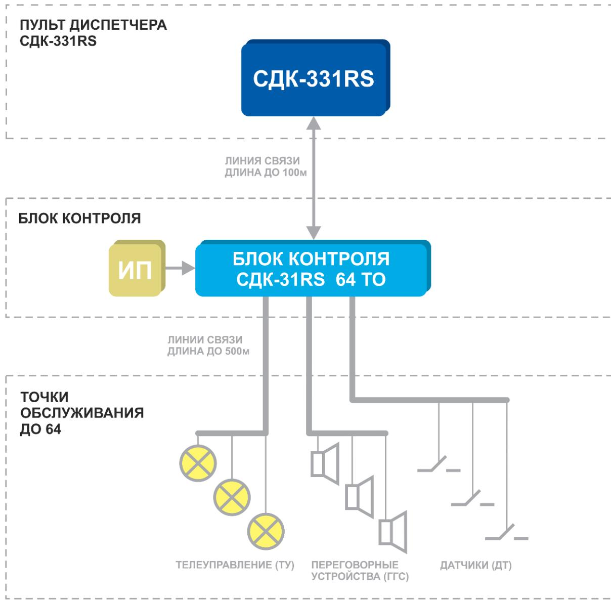
Рис. 4.1 Структурная схема системы на базе комплекса «Кристалл-331RS»
